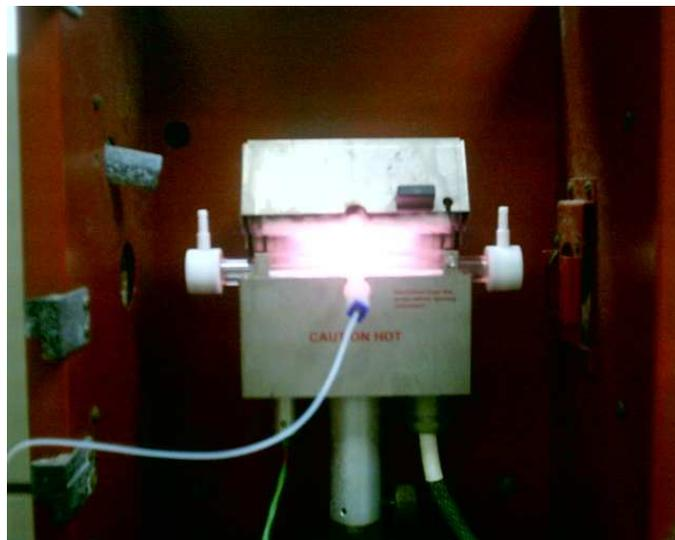
**Figura 10** – Atomizador de tubo de quartzo (QTA) aquecido com manta térmica
