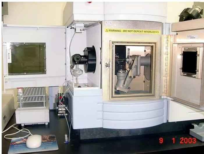
Figura 13 – Sistema PN-ICP OES
