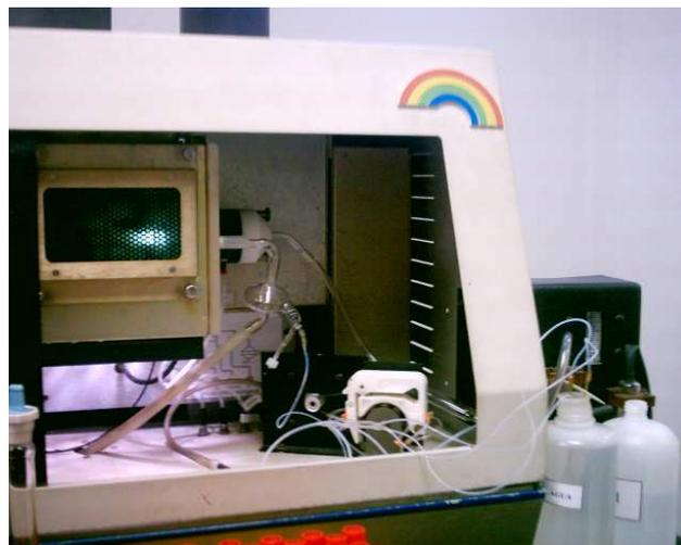
Figura 12 - Sistema CF-HG-ICP OES
