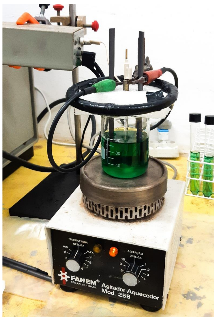
Figura 5.3 – Ensaios de voltametria cíclica da amostra \text{V}^{3+}-0,6\text{M H}_2\text{SO}_4
