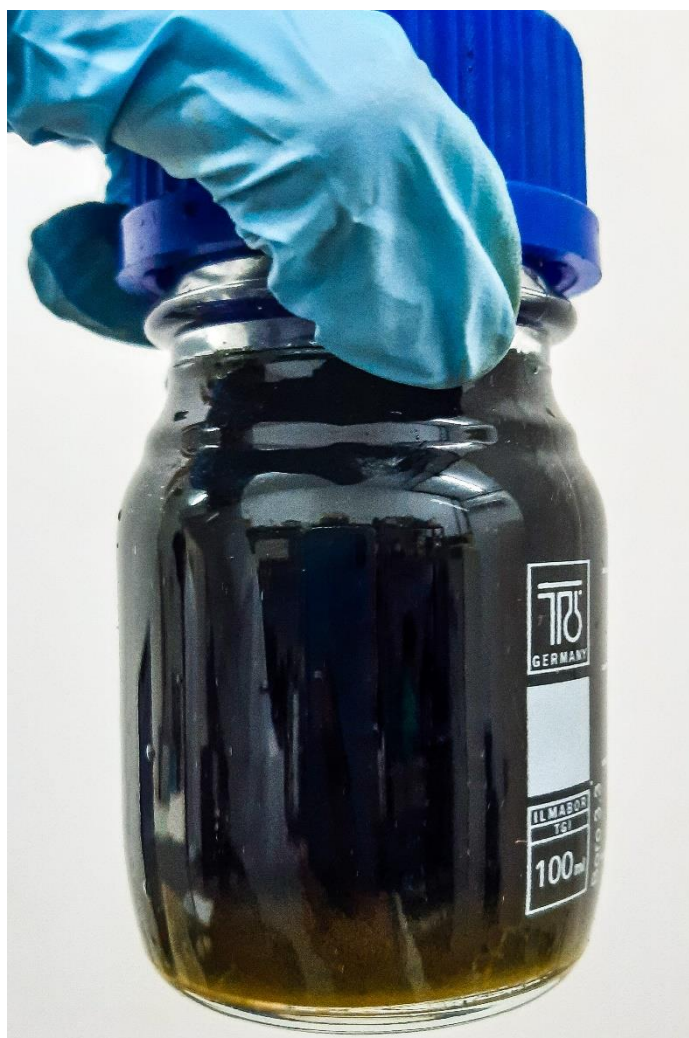
Figura 6.9 – V_2O_5 precipitado em eletrólito VO^{2+}/VO_2^+ com 5 M de H_2SO_4 e 2 M de Na_2SO_4 .
