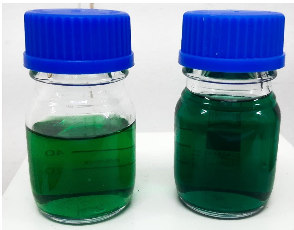
Figura 6.10 – Eletrólito \text{V}^{3+} -0,6M \text{H}_2\text{SO}_4
