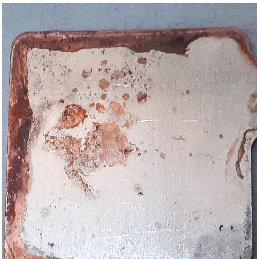
Figura 6.26 – Desgaste na superfície do coletor de corrente.
