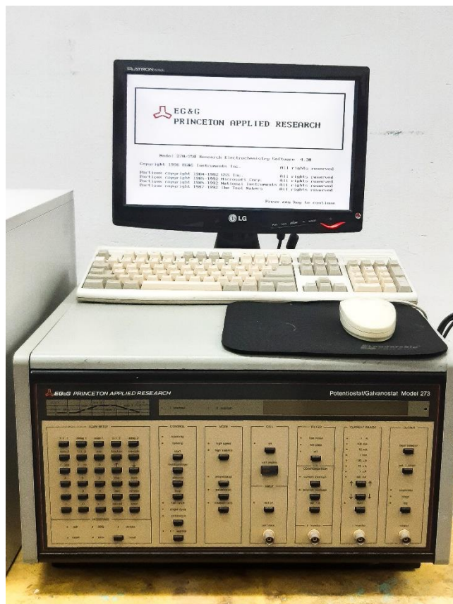
Figura 5.4 – Potenciostato-Galvanostato modelo 273 da EG&G Princeton Applied Research
