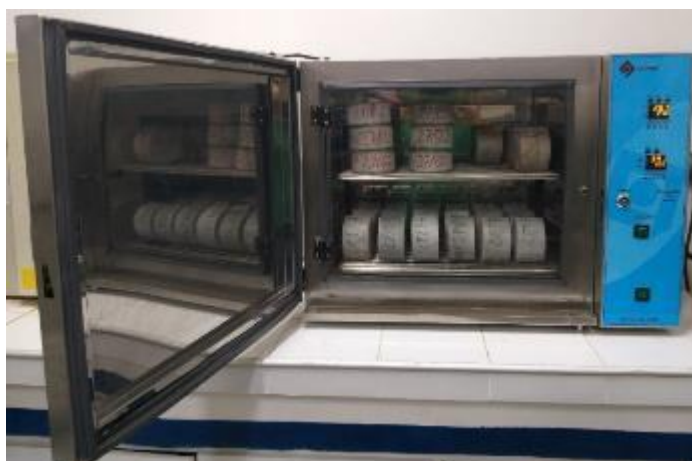
Figura 32 - Câmara de carbonatação QUIMIS utilizada na pesquisa.
