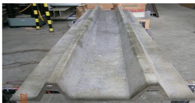
Figura 1 - Amostra de GFRC com barras de GFRP.
