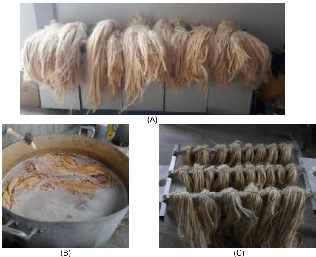
Figura 21 - (A) Aquisição e separação das fibras em lotes, (B) lavagem das fibras em água a 50 °C e (C) exposição das fibras presas em suporte metálico.
