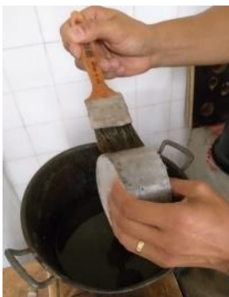
Figura 30 - Impermeabilização das laterais dos corpos de prova de concreto com parafina.
