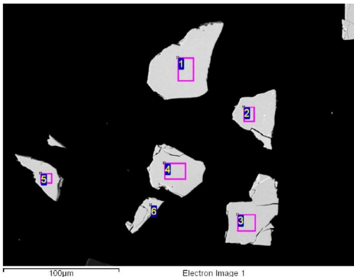
Figura 4.13 - Imagem MEV/EDS de partículas na fração  $-74+37\ \mu\text{m}$  do concentrado obtido na flotação piloto.
