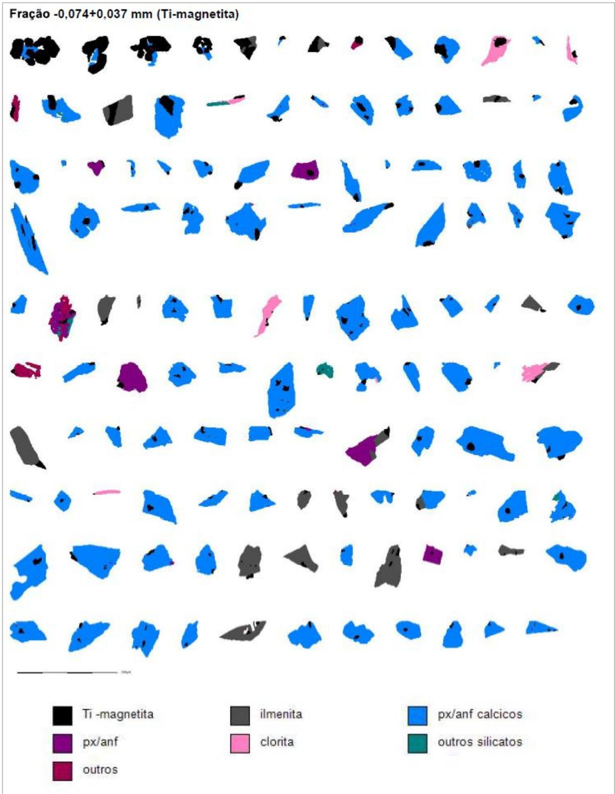
Figura D.5 - Ilustração das associações da Ti-magnetita na fração -74+37  $\mu$ m.
