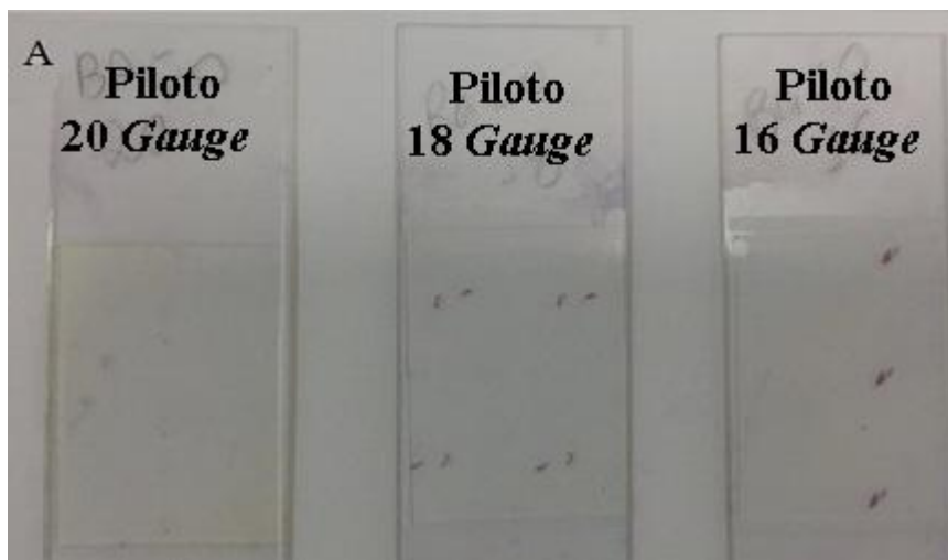
Figura 21. Fragmentos dos três calibres de agulhas Tru-cut 20, 18 e 16 Gauge. A. Lâminas dos cortes histológicos obtidos.
