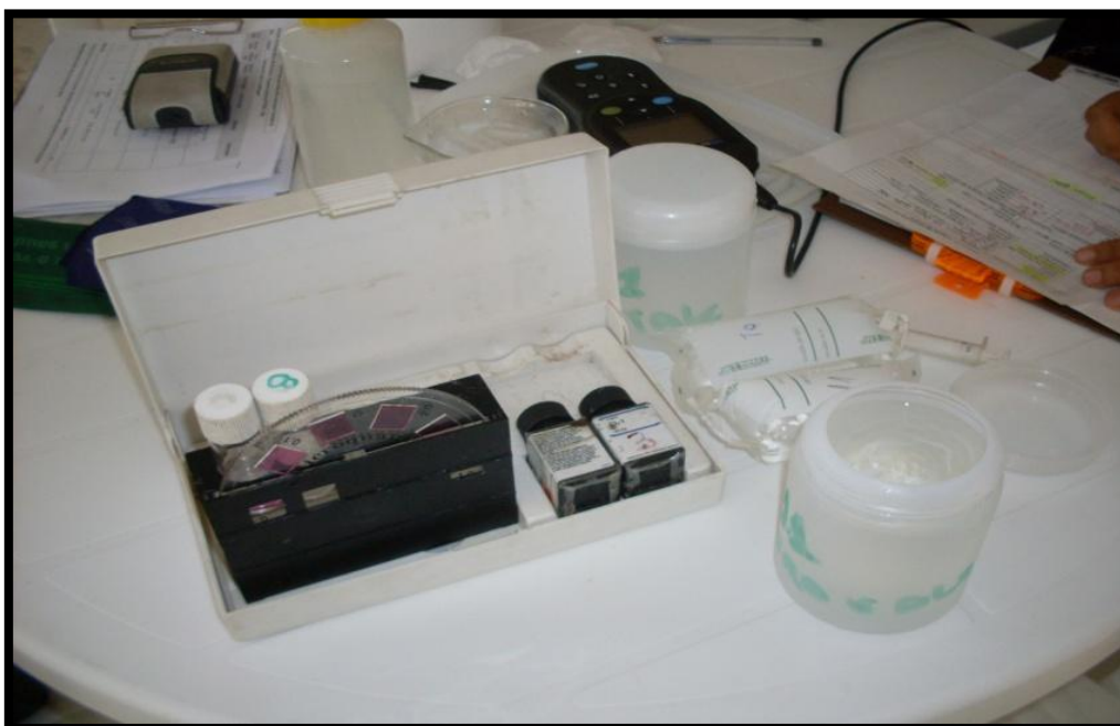
Figura 25. Colorímetro utilizado para detectar e determinar cloro residual livre
