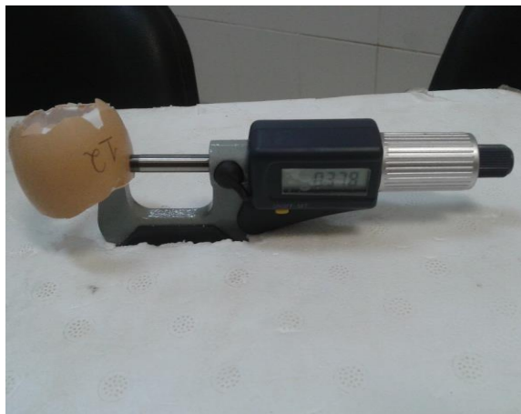
Figura 5- Medição de espessura da casca
