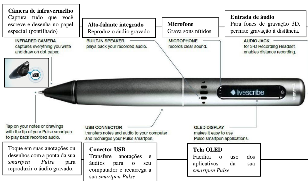
Figura 07 – Componentes da Smartpen Livescribe Pulse 12
