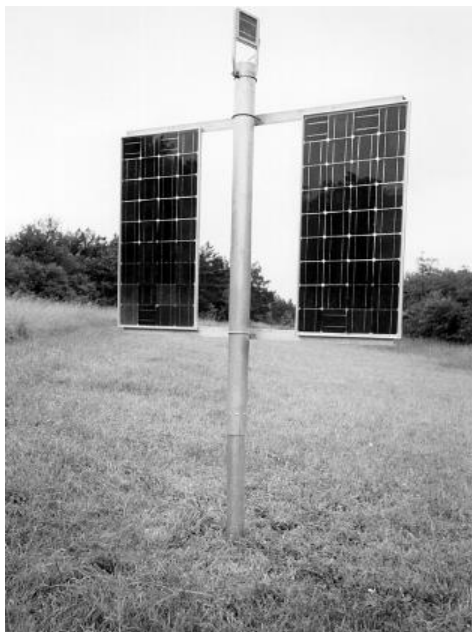
Figura 8 - Rastreador solar de um eixo, sem concentradores Fonte: POULEK; LIBRA, 2000
