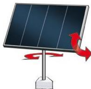
Figura 7 - Módulo solar com dois graus de liberdade de rastreamento
