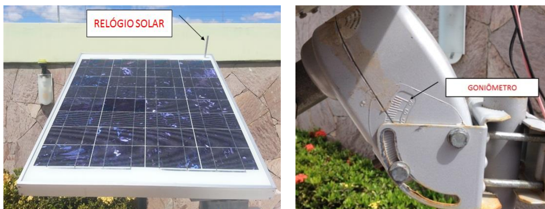
Figura 25 - Vista do módulo FV com o pino de alinhamento (relógio solar) e do goniômetro. Coordenadas Geográficas – latitude: 09°26'56"S, longitude: 40°31'27"W, altitude: 356m. Fonte: Autor
