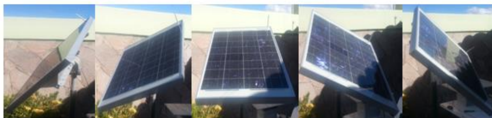
Figura 30 - Vista do módulo FV com rastreamento manual do Sol
