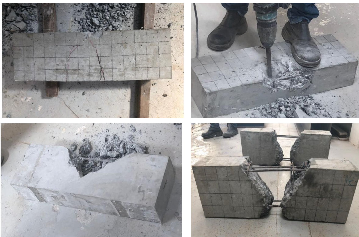
Figura 72- Remoção da região de maior solicitação da viga.
