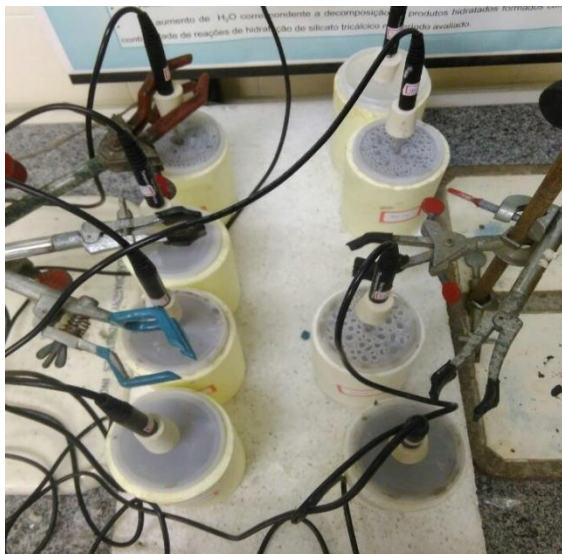
Figura 35- Ensaio de NCDTA- termistores e amostras.
