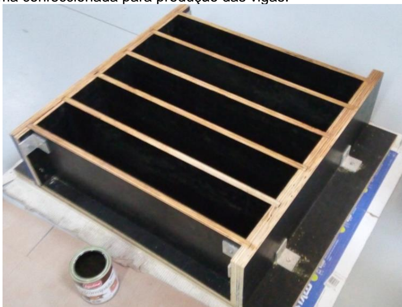
Figura 69. Fôrma confeccionada para produção das vigas.
