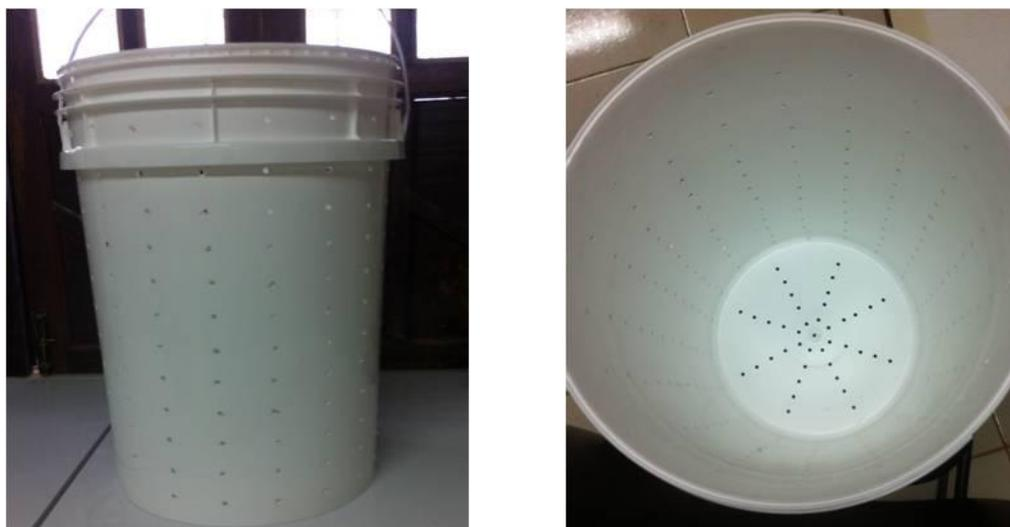
Figura 4 – Recipiente perfurado para ser utilizado como reator do processo de compostagem
