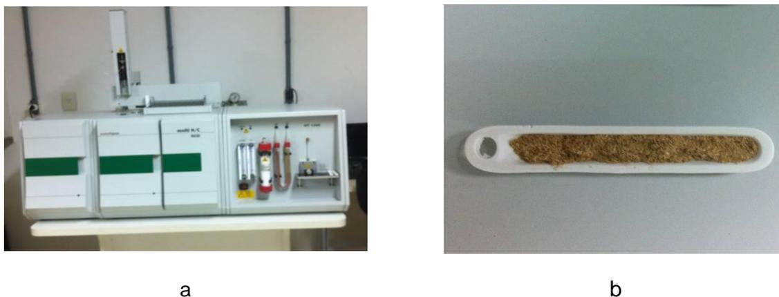
Figura 14 – Analisador de carbono orgânico total (a) e cápsula para análise de TOC (barquinha) contendo amostra sólida (b)
