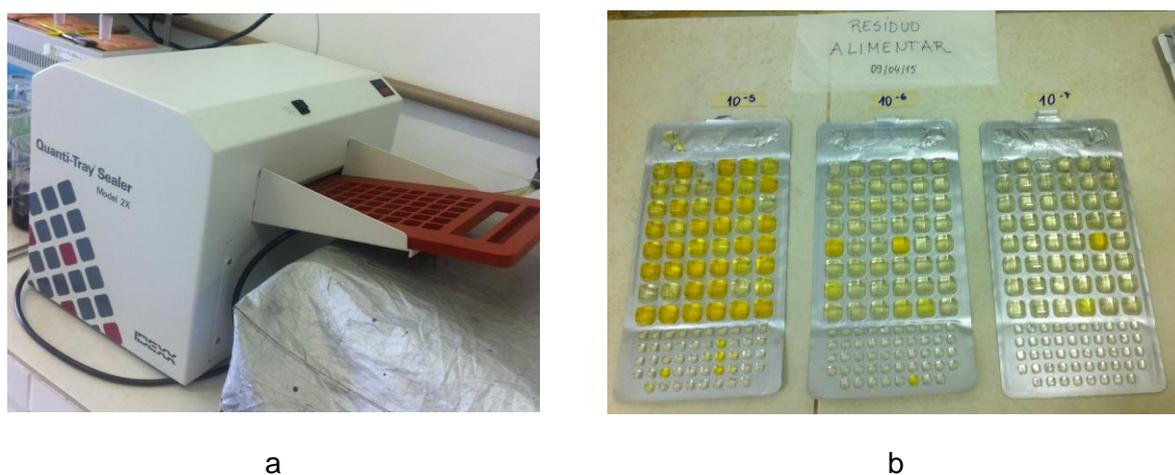
Figura 18 – Seladora para fechar hermeticamente as cartelas Quanti-Tray (a) e cartela contendo amostras para detecção de coliformes totais (b)
