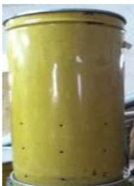
Figura 2 – Reator utilizado no sistema de compostagem (Guidone *et al.*, 2013)
