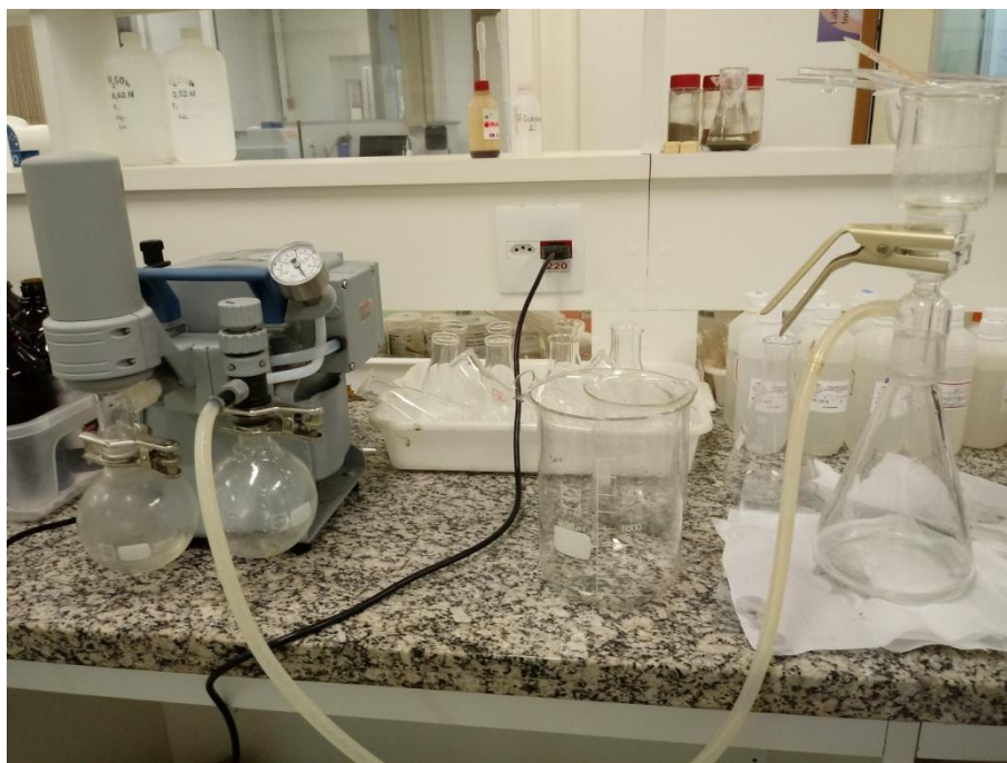
Figura 4 - Filtração da água salina em laboratório.
