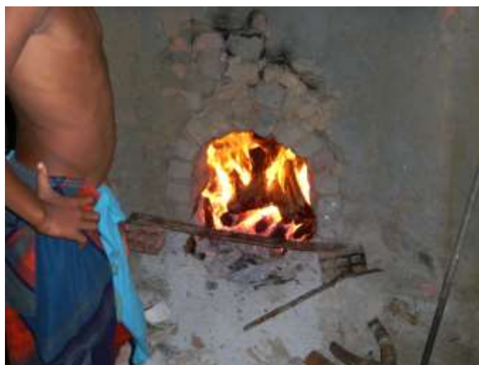
Figura 4 - Forno rudimentar utilizado para queimar panelas de barro em Maragogipinho, BA
