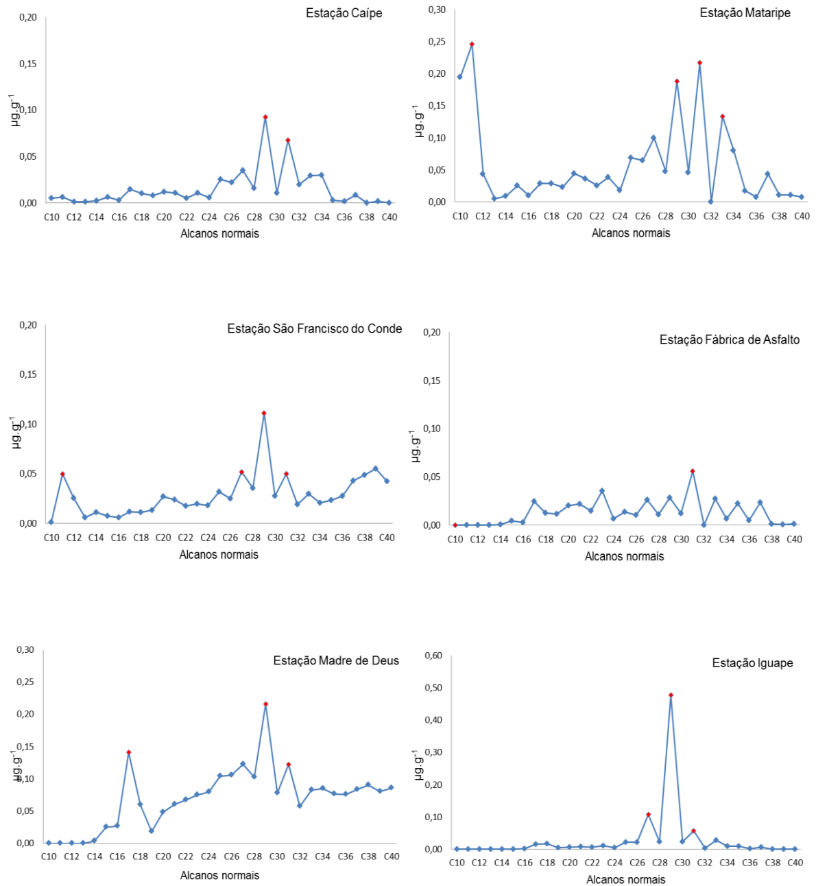
Figura 19 – A distribuição média de alcanos normais (n-C10 - n-C40), no sedimento superficial da região intermareal da BTS nas seis estações.
