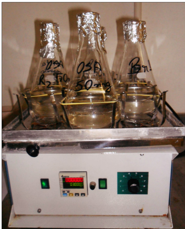
Figura 9 - Mesa agitadora onde a mistura permanece por 3 horas a 126 \text{ ciclos min}^{-1} . Exemplo do teste 1 ( 50 \text{ mg L}^{-1} ).
