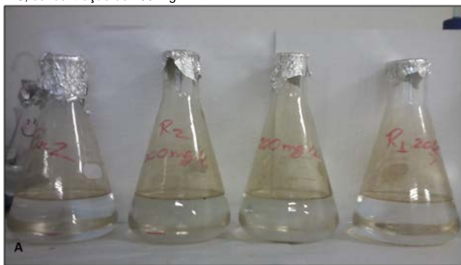
Figura 10 - Erlenmeyers depois do período overnight pós agitação: teste com óleo de Campos e MPS da BTS, concentração de 200 mg L -1 .
