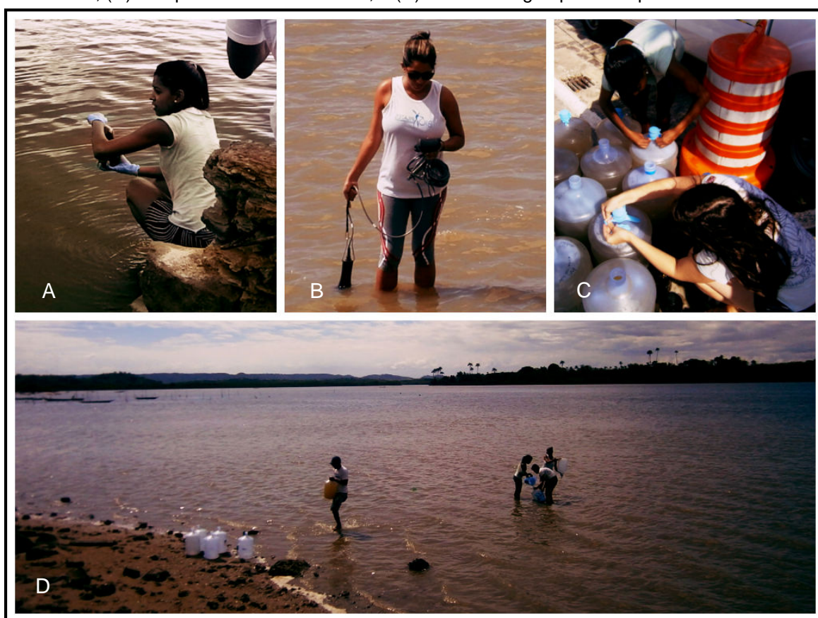
Figura 6 - Coleta da água. (A) Coleta de garrafa âmbar; (B) Medição dos parâmetros não conservativos; (C) Recipientes sendo lacrados; e (D) Coleta de água para o experimento.
