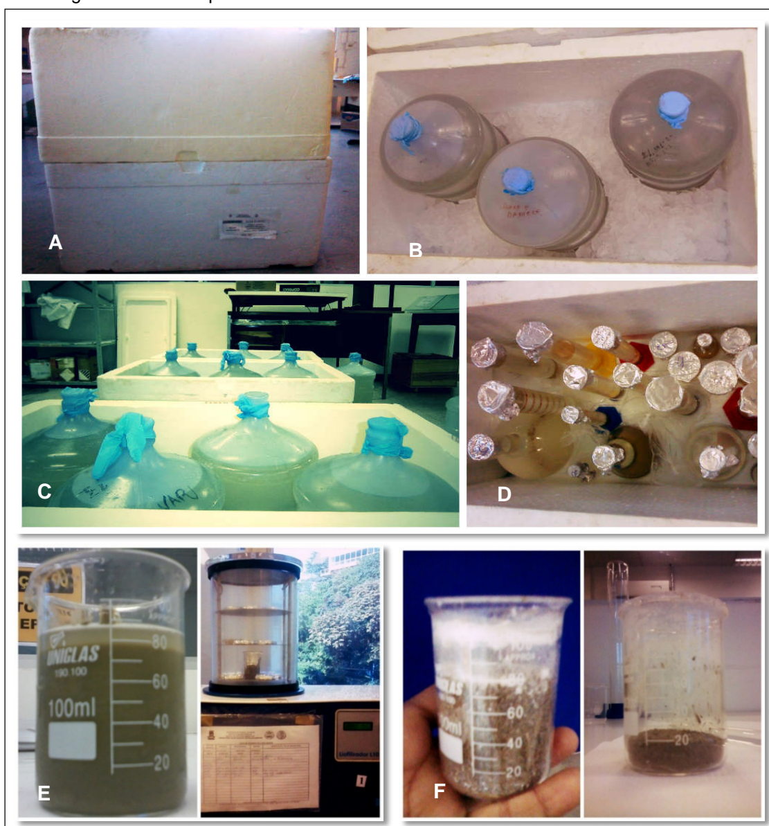
Figura 7 - Acodicionamento e pré-tratamento das amostras. As imagens de A a D são referentes ao esquema de refrigeração e decantação do MPS; E e F mostram o MPS concentrado, a etapa de retirada da água e o material particulado seco e macerado.
