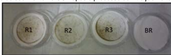
Figura 11 - Exemplo do sedimento no OSA após o processo de filtração no teste com 50 \text{ mg L}^{-1} .
