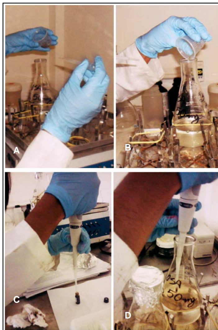
Figura 8 - Etapas de preparação da mistura: A e B mostram a adição do MPS; e C e D representam a adição do óleo.
