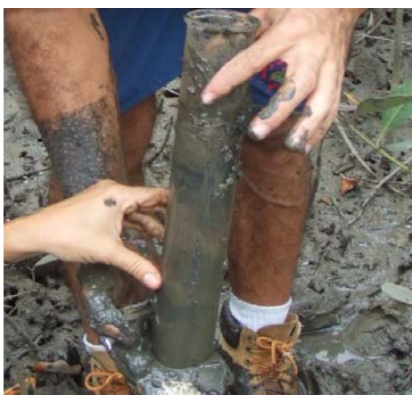
Figura 9 - Detalhe da proveta de vidro utilizada nos experimentos de biorremediação, com sedimento coletado do manguezal do rio São Paulo – BTS, BA.
