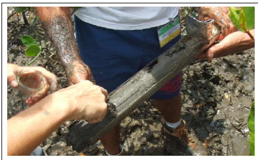
Figura 11 - Testemunhador de alumínio contendo sedimento do manguezal do estuário São Paulo que serão transferidos para as provetas de vidro dos aquários de simulação.
