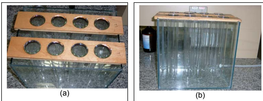
Figura 2 - Aquário com tubos de ensaio sustentados em barras de madeira (a) vista em planta, (b) vista em perfil.
