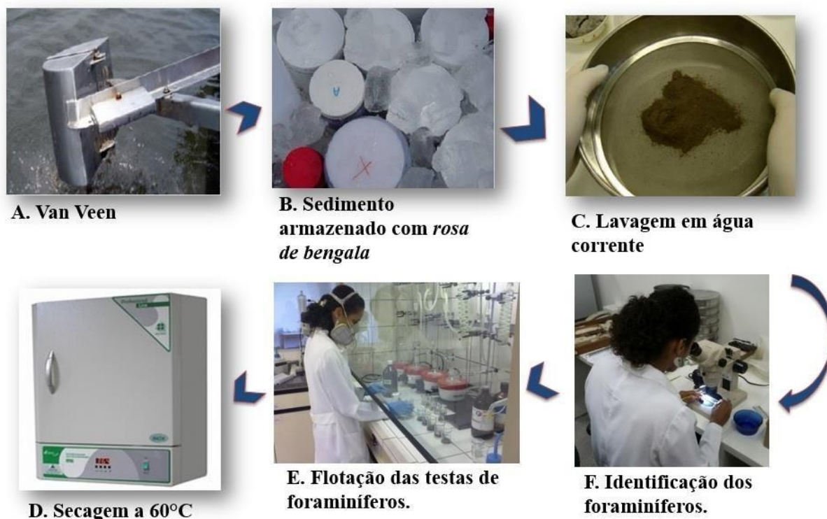
Figura 5.2 – Procedimentos de coleta e análise laboratoriais das amostras
