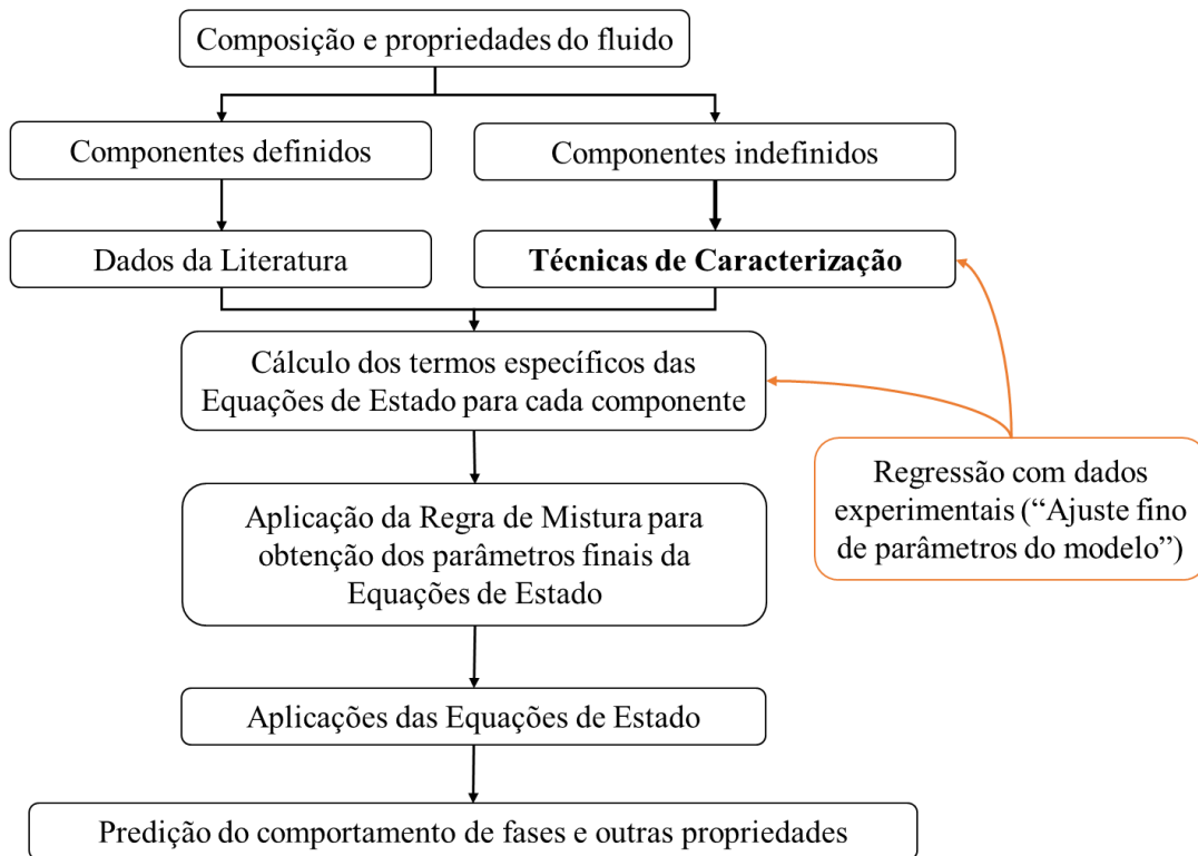
Figura 1 – Etapas necessárias para a utilização de uma equação de estado para descrever o comportamento de fases de fluidos de petróleo.
