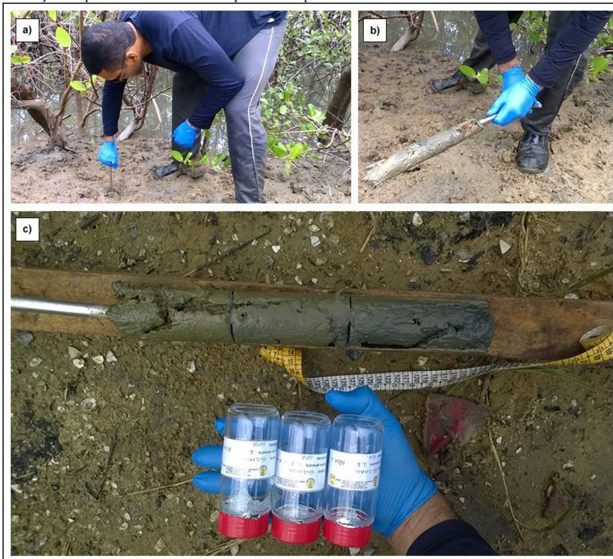
Figura 5 -Exemplos de coleta do sedimento na região do manguezal do estuário do rio São Paulo-BTS-BA: a) Colocação do testemunho em sedimento. b) Remoção do sedimento com o testemunho. c) Subdivisão e destinação das partes do sedimento em respectivos recipientes de vidro devidamente identificados
