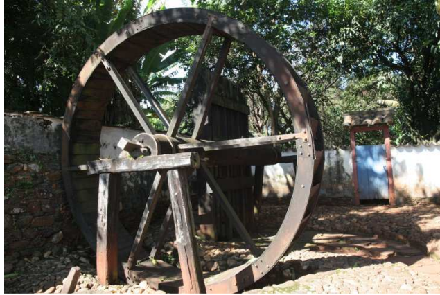
Museu do Ouro. Área externa. Objeto: roda fixa para movimentação de engrenagem para moer minério para extração do ouro. ACERVO MUSEU DO OURO. Foto: JOTAERRE.
