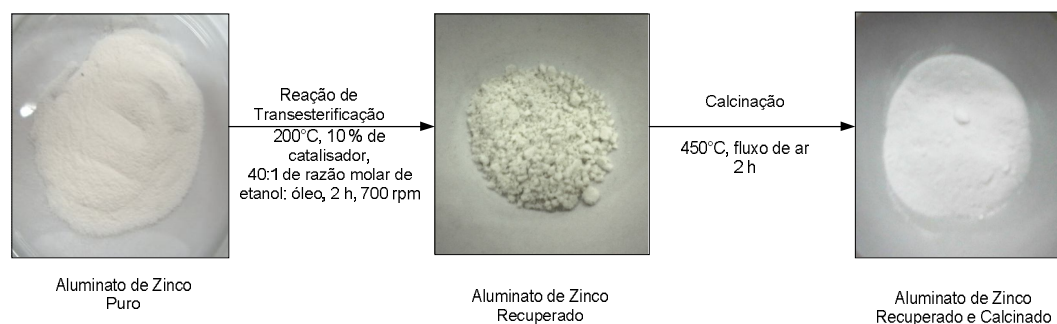
Figura 47: Diferença de coloração entre o aluminato de zinco puro, recuperado da reação de transesterificação antes da calcinação e após a calcinação.
