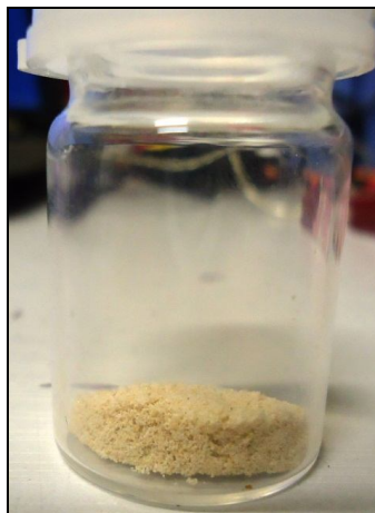
Figura 44: Amostra de \text{ZnAl}_2\text{O}_4 recuperado da reação de transesterificação
