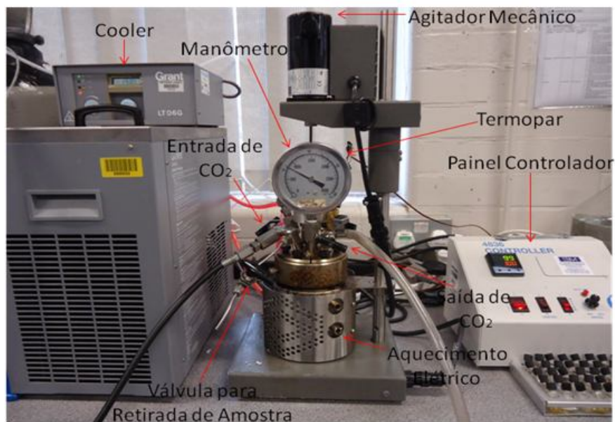
Figura 43: Reator utilizado com CO 2 supercrítico
