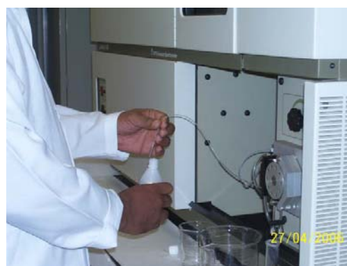
Foto 6: Análise da amostra no ICP OES. Detalhe do sugador.
