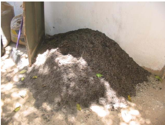
Vista da areia retirada , apresentando cor escura.
