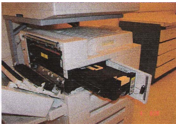
Suporte do OPC sendo instalado na Máquina XEROX
