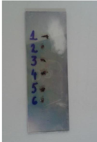
Figura 8. Lâmina de minerais selecionados para análise em MEV e EDS.
