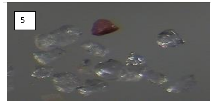
Figura 30: Minerais leves do perfil 10 - 1 – Quartzos subangulares e transparentes; 2 – Quartzos rosas e subangulares; 3 – Quartzos totalmente transparentes e subangulares; 4 – idem; 5 Quartzos transparentes e rosas, subangulares.
