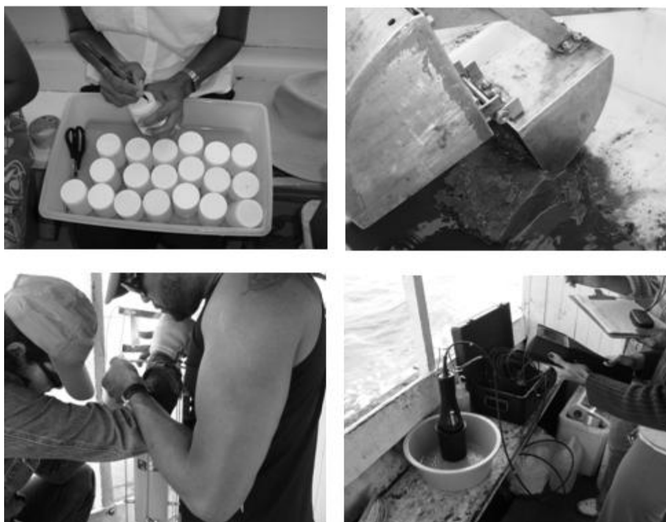
Figura 6. Processo de coleta de dados em campo: obtenção de amostras para análise de foraminíferos e granulometria por meio da draga Van Veen; tomada de dados ambientais utilizando a sonda multiparâmetros
