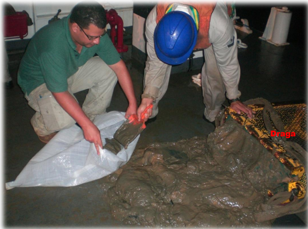
Foto 11 – Amostragem de sedimentos superficiais no mar, com auxílio de uma draga.
