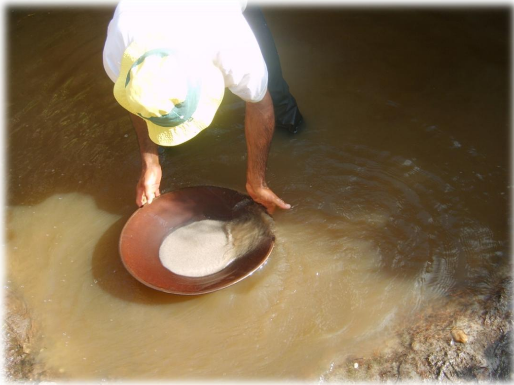
Foto 10 - Bateia utilizada para concentração de minerais pesados na fração entre 0,25 – 0,5 mm.
