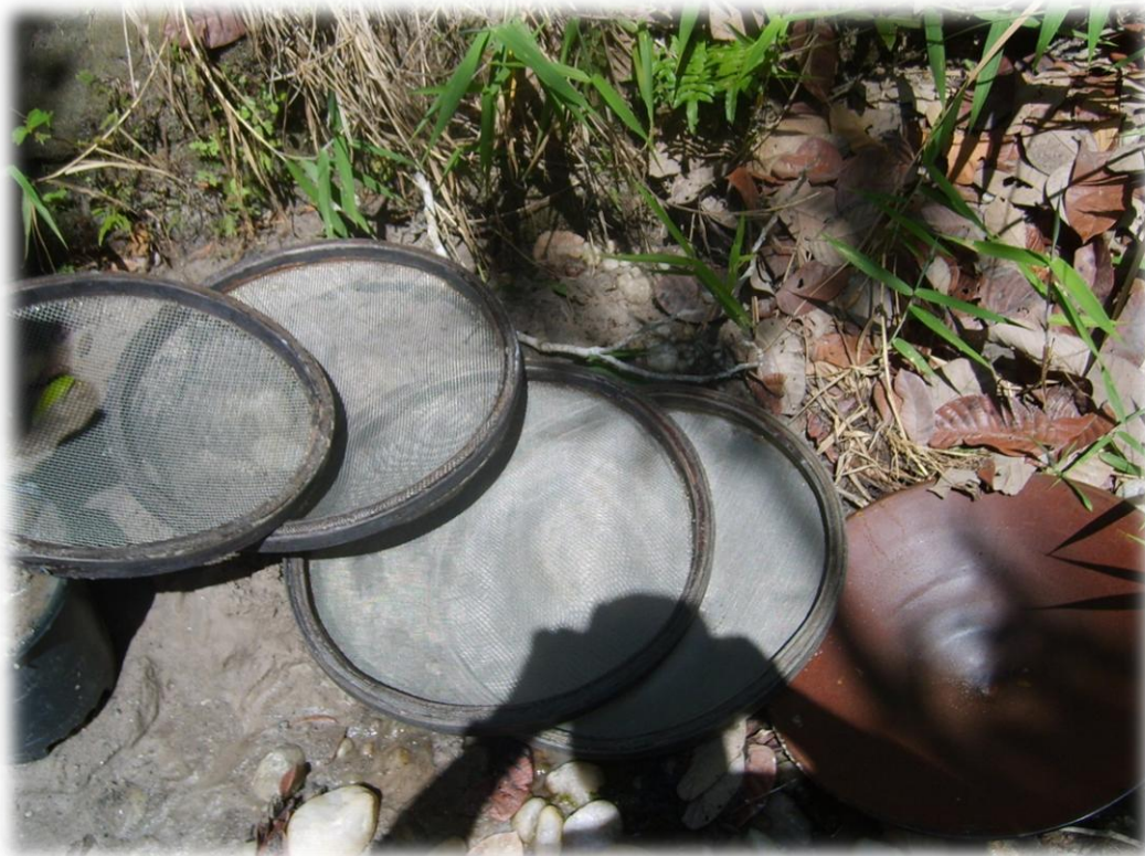
Foto 6 – Jogo de peneiras e batéia utilizada na concentração de minerais pesados
