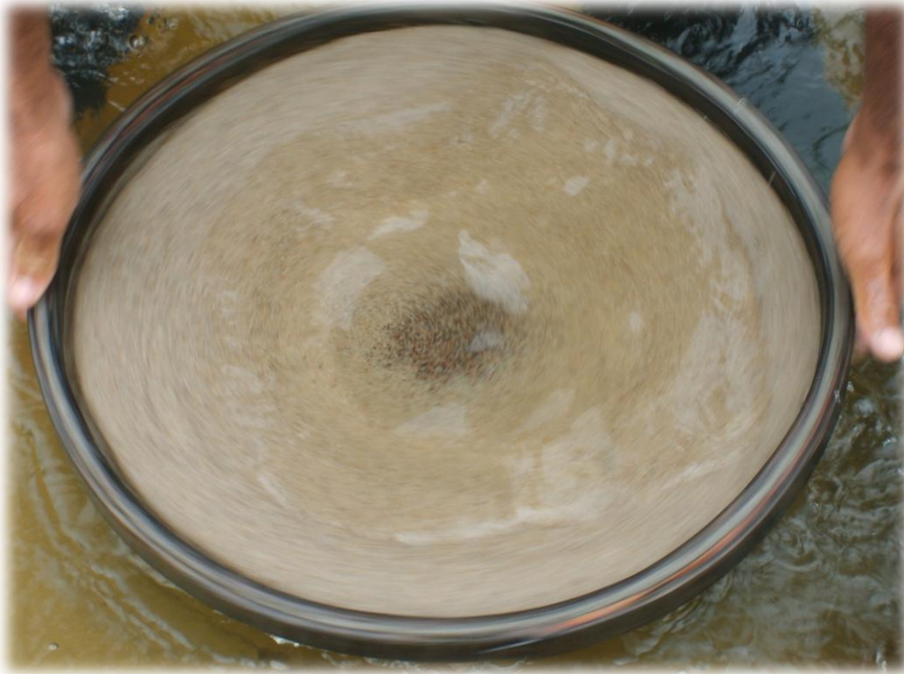
Foto 8 - Peneira de # 16 com concentrado de minerais pesados no centro.
