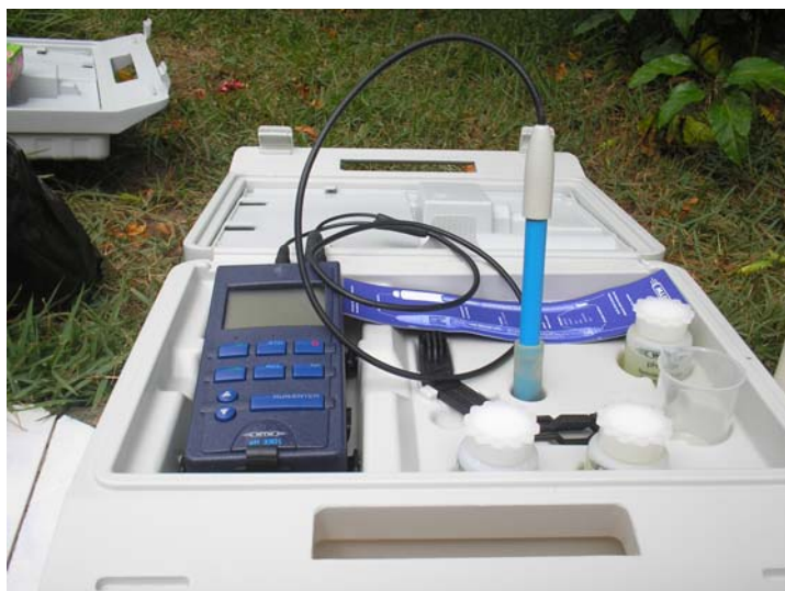
Figura 2.14: Aparelho utilizado para medir a alcalinidade total da água.
