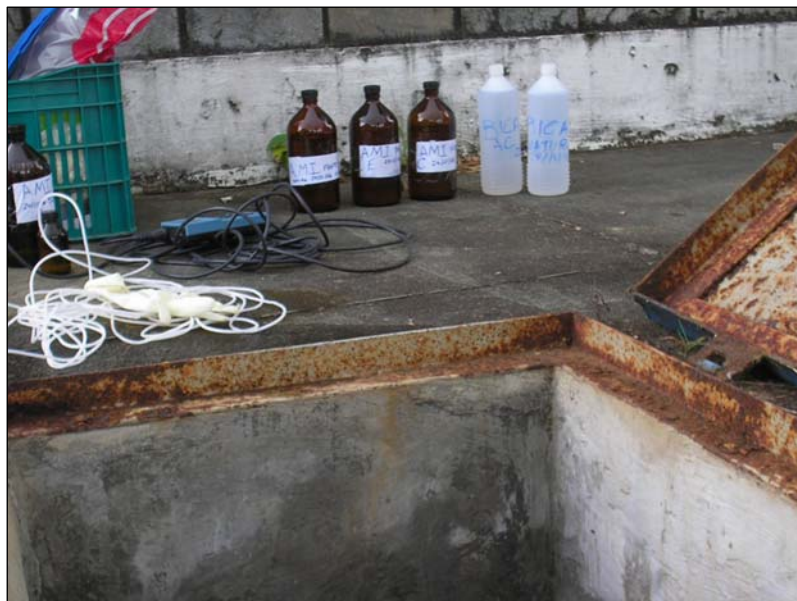
Figura 2.12: Frascos de amostragem, recipiente em âmbar e garrafas de plástico destinadas a análises físico-químico e isotópica.
