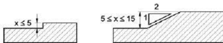
Figura 06- Tratamento de desníveis (dimensões em mm).
