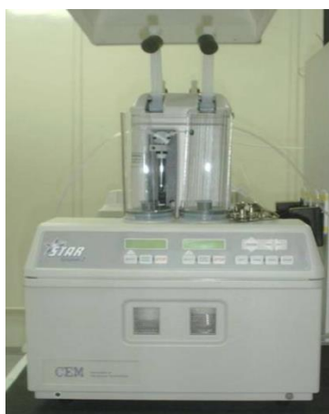
Figura 5. Forno de microondas com radiação focalizada STAR 2, CEM, Matthews, N.C., EUA
