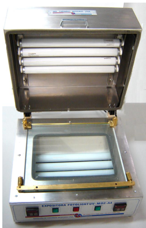
Figura 6. Fotoexpositora utilizada para a exposição do substrato à radiação UV
