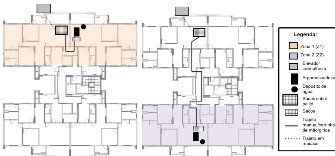
Figura 71: Representação do transporte da argamassadeira e sacos pelo andar (Fonte: O autor)
