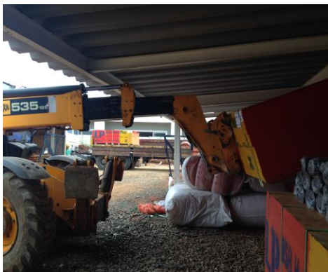
Figura 112: Equipamento impactando na cobertura do armazém para estocar o material (Fonte: O autor)
