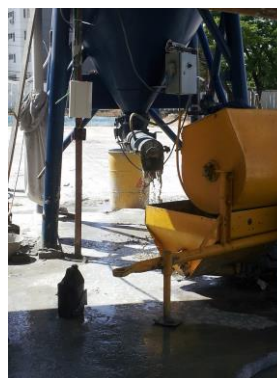
Figura 34: Argamassadeira situada abaixo da boca do silo (Fonte: O autor)
