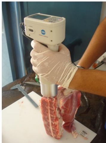
Figura 16. Avalia o da cor da carne ovina atrav s da colorimetria
