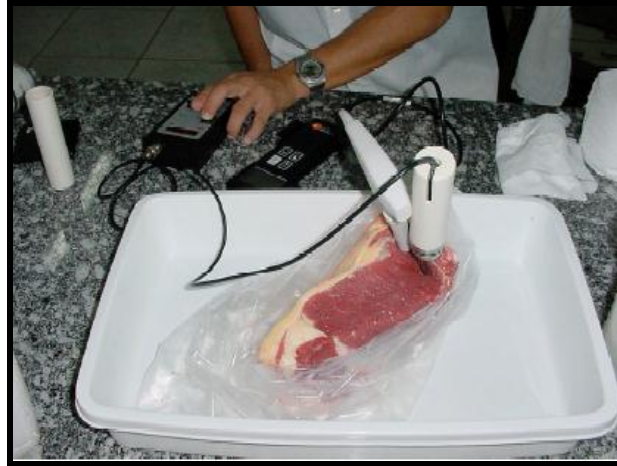
Figura 15. Avaliação do pH da carne ovina através do pHmetro.
