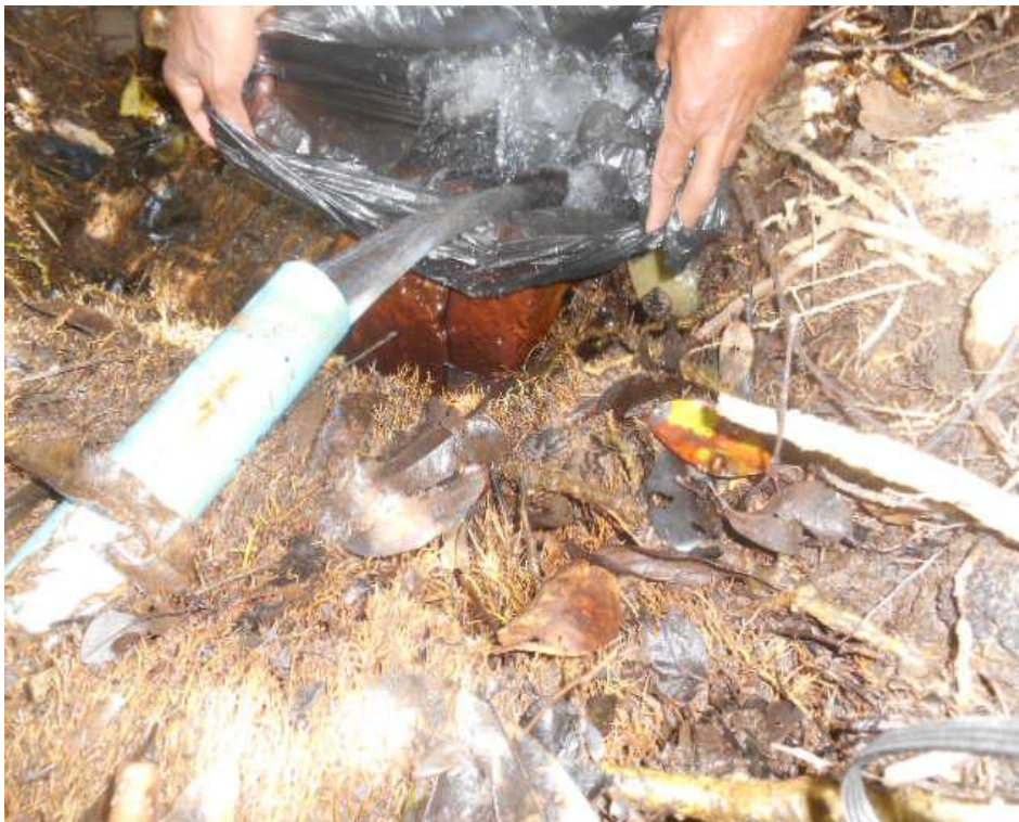
Figura 9 - Medição de vazão em sacolas plásticas adaptáveis ao substrato do fluxo
