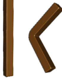
Figura 3.8 Bend aplicado em uma barra, do lado esquerdo temos o objeto original e do lado direito o deformado. Imagens geradas no programa MeshDeform .
