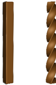
Figura 3.7 Twist aplicado em uma barra, do lado esquerdo temos o objeto original e do lado direito o deformado. Imagens geradas no programa MeshDeform .
