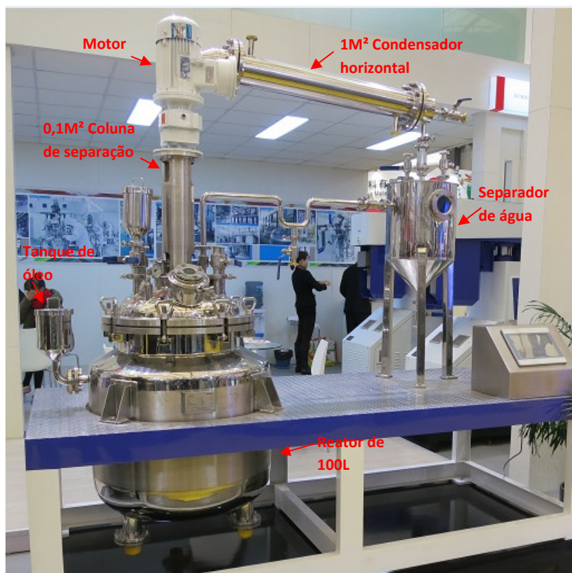
Figura IV.12: Reator de 100 l da Sower Group (figura adaptada).
