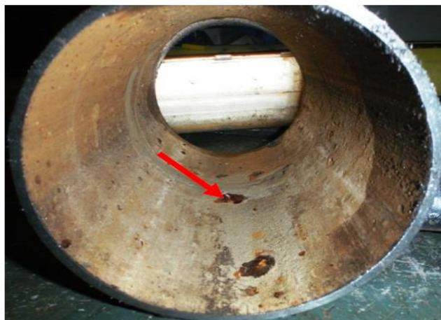
Figura 16 – Corrosão com ocorrência de pite. (Boivin e Oliphant, 2011).
