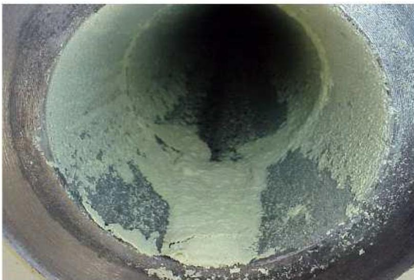
Figura 5 – Enxofre elementar depositado a jusante de regulador de pressão (PACK, 2005).
