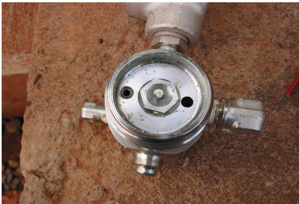
Figura 3 – Enxofre elementar depositado em um regulador de pressão (Pack, 2005).
