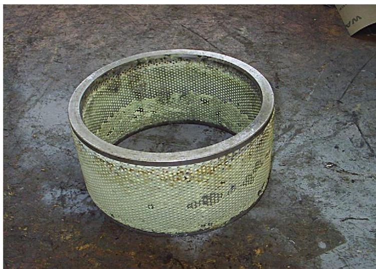
Figura 18 - Válvula do tipo gaiola labirinto mostrando depósitos de enxofre elementar. (PACK *et al.*, 2012).
