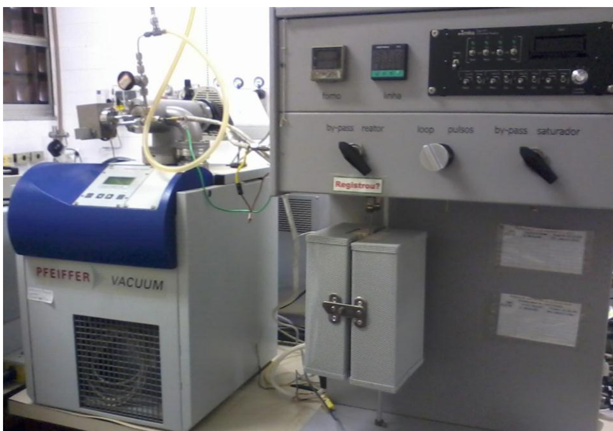
Figura 3.6 - Espectrômetro de Massas utilizado nas análises de TPR-H 2 , TPSR e TPO.
