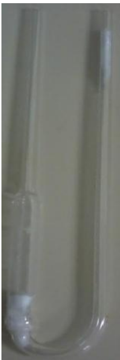
Figura 3.5. Reator em U utilizado nas análises realizadas no Espectrômetro de Massas e Cromatógrafo a gás.
