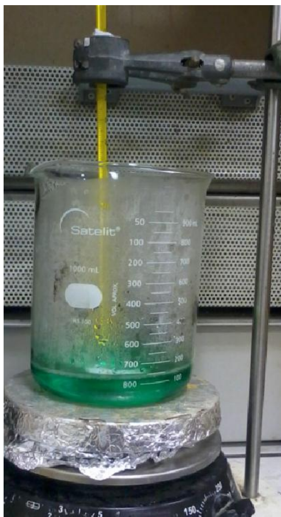
Figura 3.1. Síntese dos precursores perovskitas pelo método citrato.
