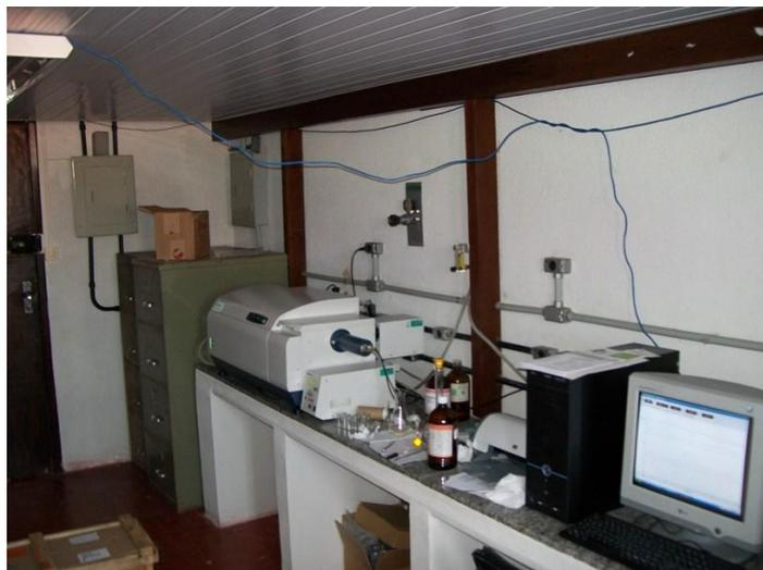
Figura 20- Foto do sistema acoplado utilizado para medidas de Absorção no UV-vis, Dicroísmo Circular e Emissão de Fluorescência.
