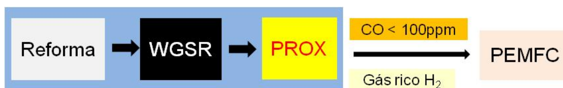
Figura 2.3 Esquema geral de um processo químico para a obtenção e purificação do hidrogênio, adaptado (ZHANG et al. , 2012).
