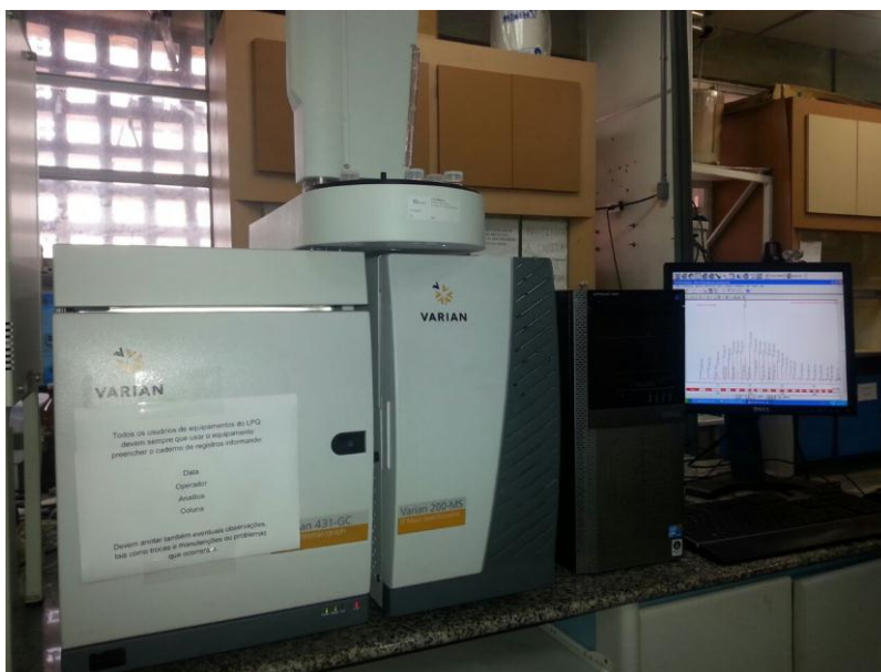
Figura 9 – Sistema GC-MS utilizado na determinação de hidrocarbonetos alifáticos, associados a material particulado.
