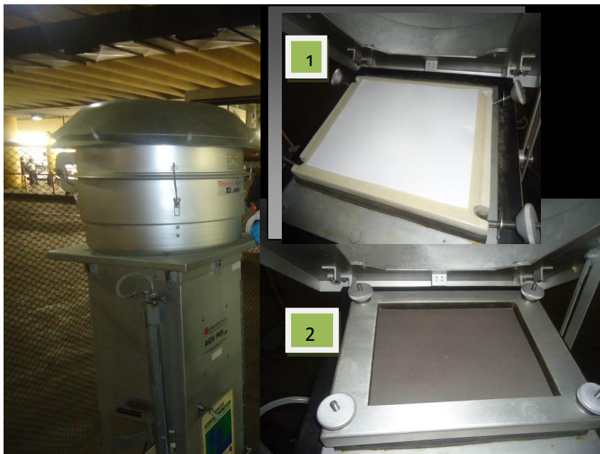
Figura 12 - Amostrador do tipo Hi-Vol utilizado na amostragem: em destaque, um dos filtros (1) antes e (2) após a amostragem.
