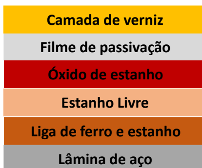
Figura 1. Corte transversal de uma folha de flandres.
