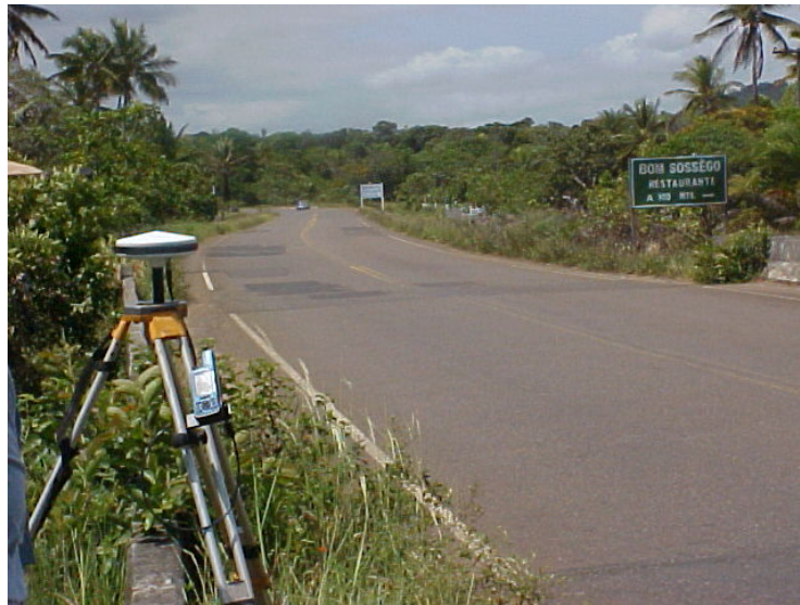
Figura 42 - Equipamento GPS de frequência L1 em rastreo na região de Ilhéus.
