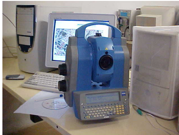
Figura 47 – Estação Total Zeiss ELTA S20 Fonte: LABGEO/DT/UFBA
