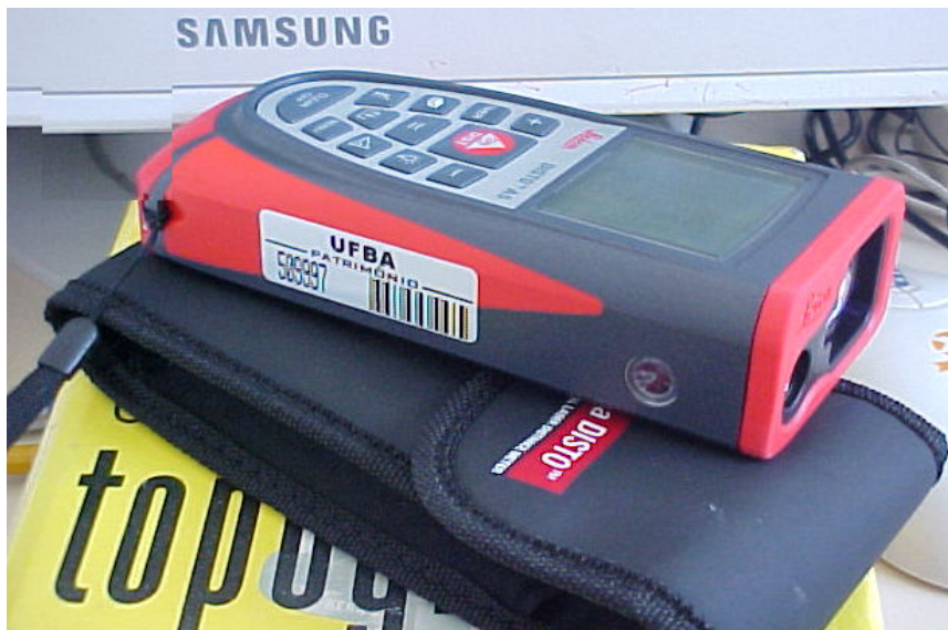
Figura 54 - Trena a laser da Leica, série Disto™A5. Fonte: LABGEO – DT - UFBA
