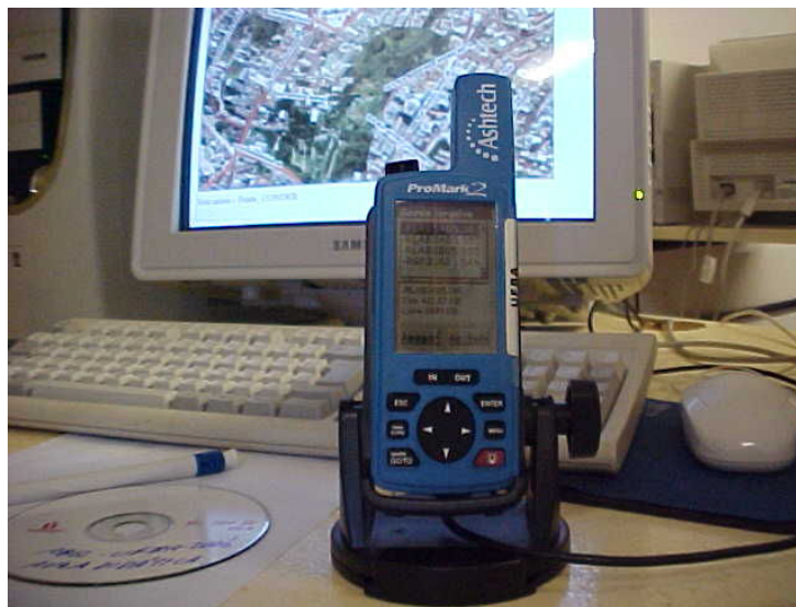
Figura 43 - Equipamento GPS fazendo download. Foto-Fonte: LABGEO-DT-UFBA, 2006.
