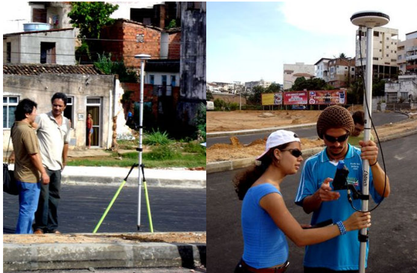
Figura 44 – GPS L1 no modo estático em bipé. GPS L1 no modo “stop-and-go”.
