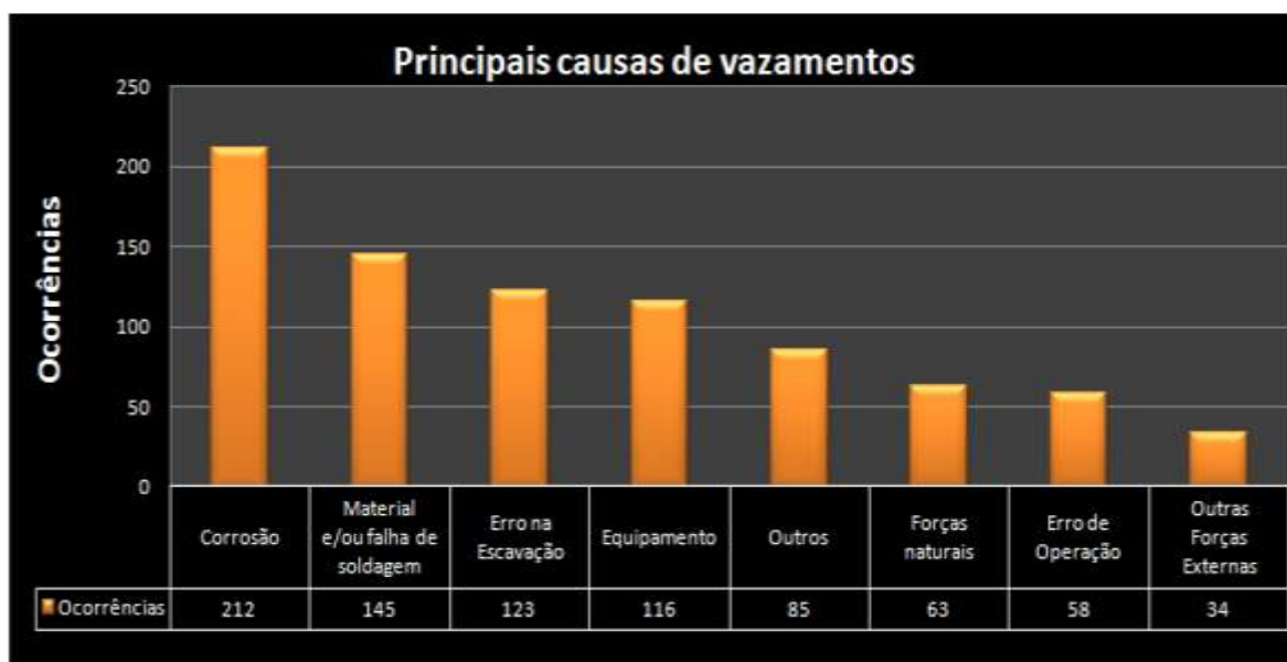
Figura 1.2 - Principais causas de vazamento (3).
