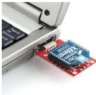
Figura 4.16 - XBee conectado ao microcomputador através do XBee Explorer.
