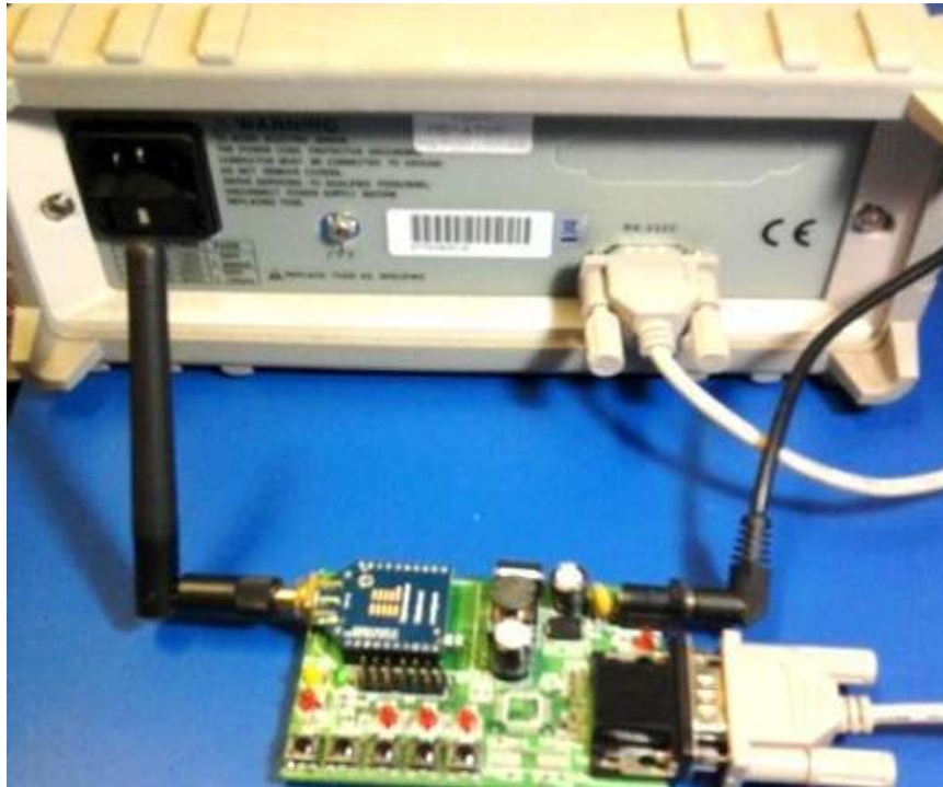
Figura 3.27 - Conexão Xbee+INT700+Multímetro digital
