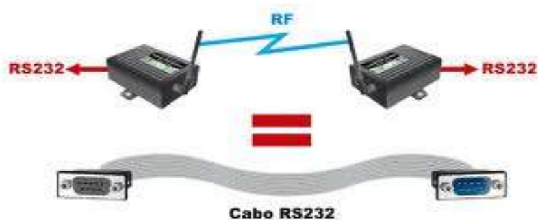
Figura 3.20 - Conexão ponto a ponto XBee (23).
