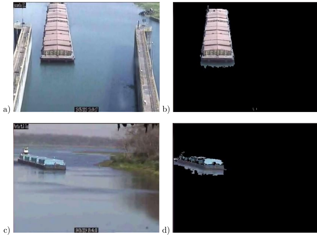
Figura 4.17: Resultado final do pipeline de visão computacional aplicado a vídeos de duas eclusas no rio Tietê: (a) exemplo de frame de entrada retirado da eclusa NAV e (b) o resultado da segmentação da embarcação nesta eclusa; (c) exemplo de frame de entrada retirado da eclusa IBI e (d) o resultado da segmentação da embarcação nesta eclusa. Fonte: elaborado pelo autor.
