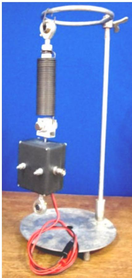
Figura 86 - Protótipo montado com a célula de carga dentro da caixa e acessórios
