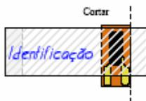
Figura 131 - Corte da fita suporte rente ao SG
