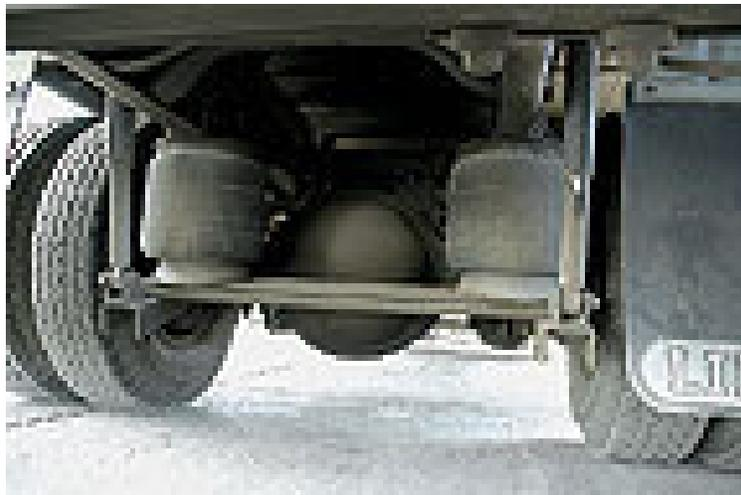
Figura 8 – Bolsas pneumáticas montadas entre a suspensão e chassi.
