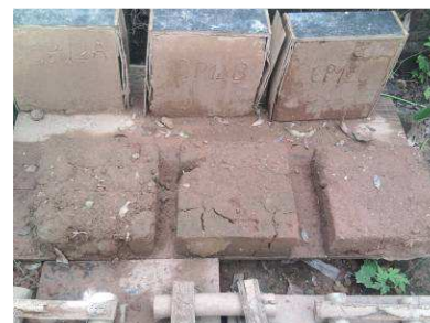
C CP 11 A, B e C – Módulo de bambu com broca + terra
