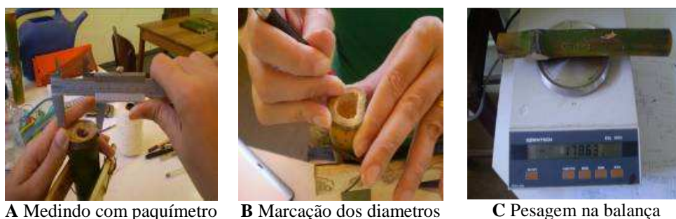
Figura 54 Medidas dos montantes dos corpos de prova
