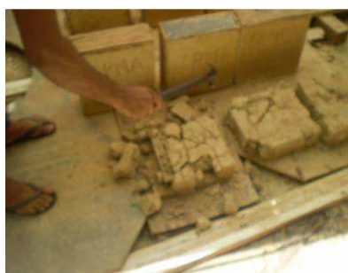
J Demolição dos Corpos de Prova
