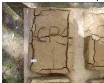
B Rachaduras no CP 01 após a 2ª semana
