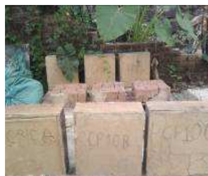
C Corpos de prova CP 10 A, B e C – Modulo de Terra com reboco
