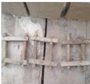
A Corpos de Prova CP 08 A,B e C – Entramado de Bambu verde
