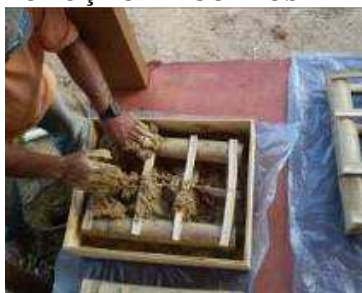
A Corpo de prova sendo preenchido com a terra utilizando forma de madeira
