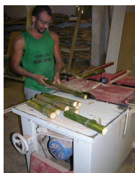
B Corte do bambu
