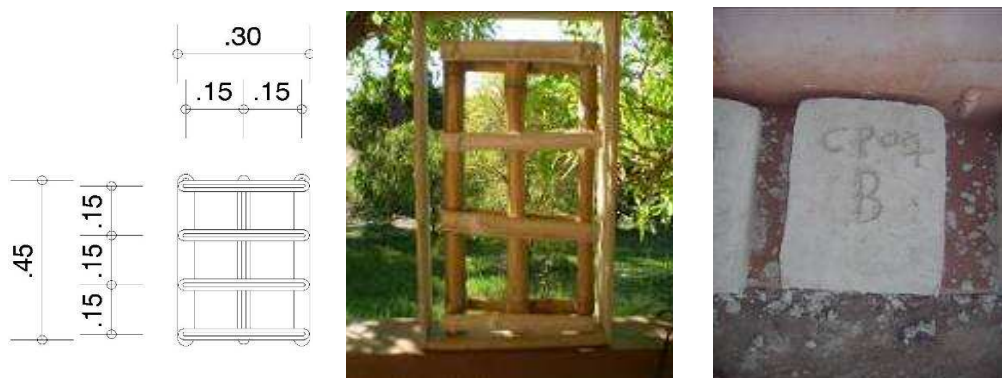
Figura 43 Entramado, entramado na forma, corpo de prova pronto.
