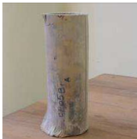
Figura 61 Dobramento na parte inferior
