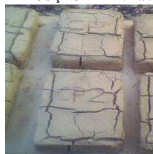
B Detalhe das rachaduras nos CPs
