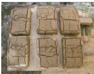
A Rachadura após a 1ª semana
