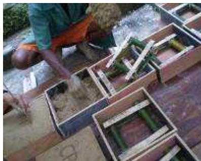
B CPs sendo preenchidos com a terra utilizando forma de madeira.
