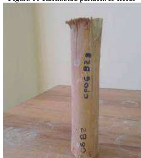
Figura 62 Dobramento na parte superior
