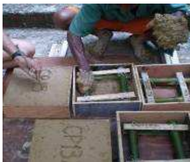
A Preenchimento de camada com 2cm e colocação do entramado
