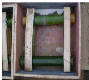
Figura 55 Moldura de madeira para a produção do corpo de prova.
