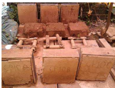
B CP 10 A, B e C – Módulo de Terra com reboco
