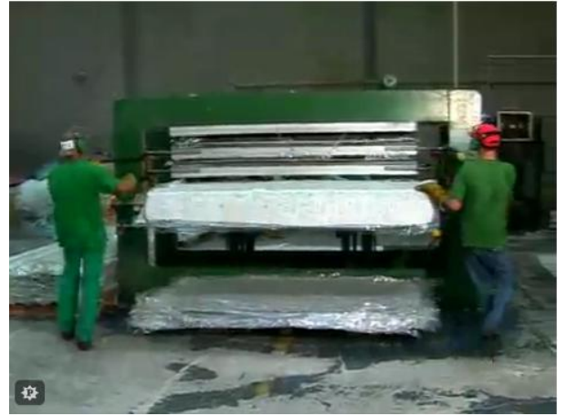
Figura 22.b: Prensa aquecida à 180°C Fonte: SEBRAE, 2009
