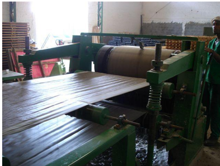
Figura 13 – Formação da manta fibro-vegetal
