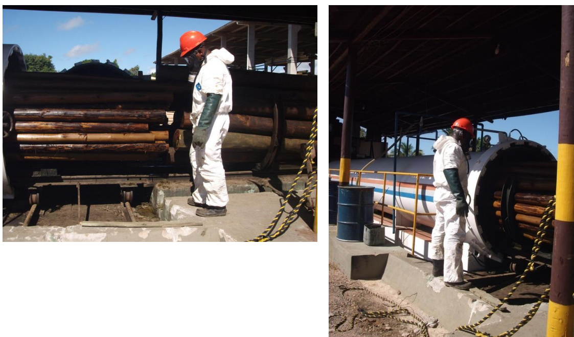
Figura 34: Funcionário recebendo a madeira impregnada de CCA na saída do cilindro autoclave (vista frontal e lateral)
