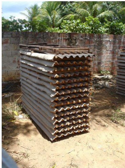
Figura 15 – Telhas em estrado para secagem ao ar livre
