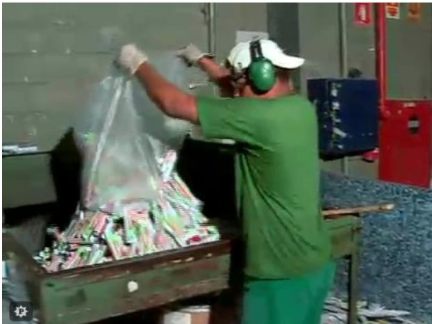
Figura 20.a: Embalagem de creme dental em triturador Fonte: SEBRAE, 2009
