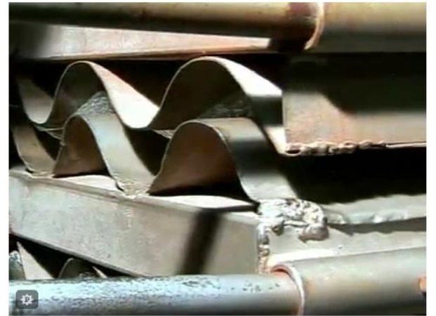
Figura 23.b: Forma de ondulação da telha Fonte: SEBRAE, 2009
