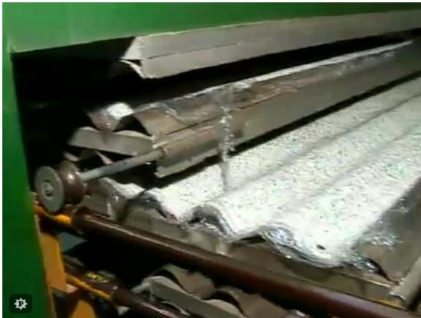
Figura 23.a: Forma de ondulação da telha Fonte: SEBRAE, 2009
