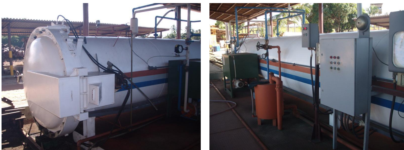
Figura 33: Cilindro autoclave para impregnação de CCA – Vistas frontal e lateral
