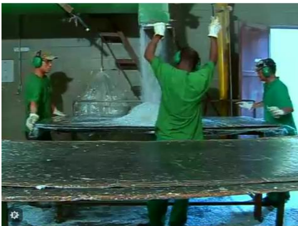
Figura 21.a: Polietileno triturado - saída para bandeja Fonte: SEBRAE, 2009
