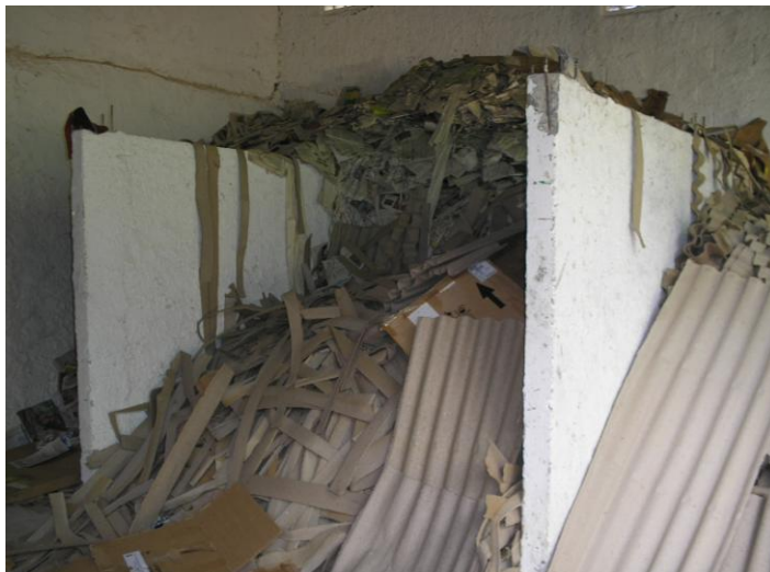
Figura 11 – Silos de papel da para fabricação da telha “ecológica” com resíduo de papel.
