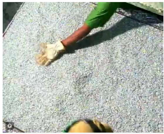
Figura 21.b: Polietileno triturado espalhado manualmente na bandeja Fonte: SEBRAE, 2009
