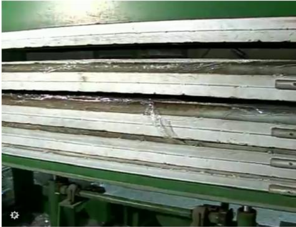
Figura 22.a: Prensa aquecida à 180°C Fonte: SEBRAE, 2009
