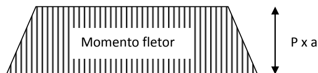
Figura 25 – Momento fletor na flexão a quatro pontos (NASH, 1974)
