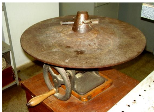
Figura 38 – Mesa de consistência, molde e soquete metálico
