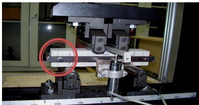
Figura 51 – Região da extração das amostras para o ensaio de MEV-EDS
