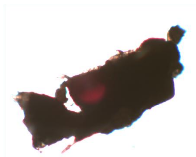
Figura 53 – Partícula de PEADr (ampliação 6X)
