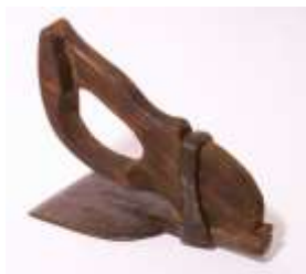
Figura 70 – Modelo de enxó muito usado pelos escultores de Cachoeira.
