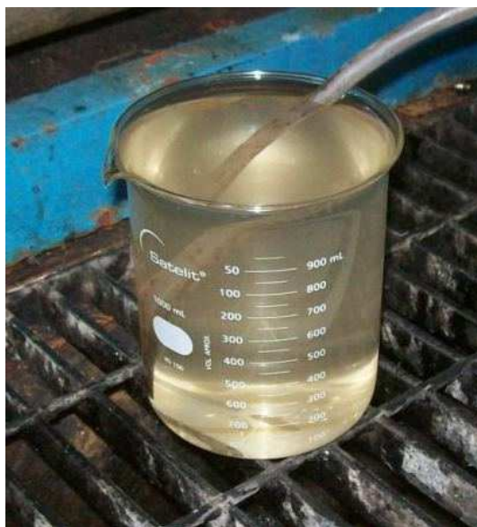
Figura 25 – Aspecto da água na 1ª etapa de lavagem do leito com a solução de detergente - ao final desta etapa
