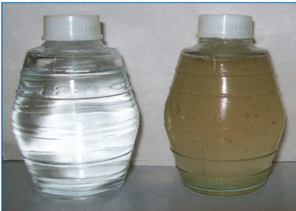
Figura 59 – Aspecto visual de duas amostras de AP antes de após o tratamento pelo processo de membranas estudado.
