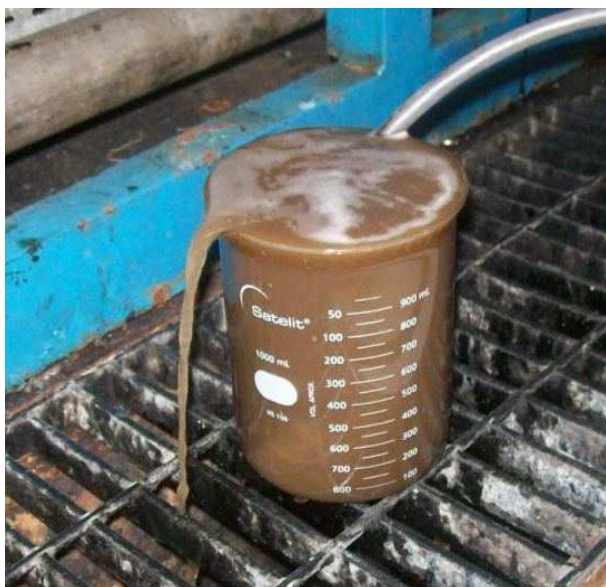
Figura 24 – Aspecto da água na 1ª etapa de lavagem do leito com a solução de detergente - no início da etapa
